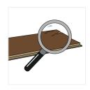
Compruebe, en condiciones lumínicas óptimas, que las lamas no tengan defectos visibles tanto antes como durante la instalación. No se deben utilizar lamas con defectos.
